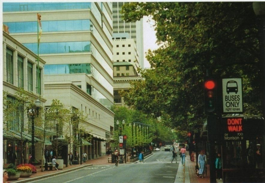
▲五番街・3車線部のトランジット・モール。荷物搬入車両等の動線を確保するため、部分的に3車線にしている
