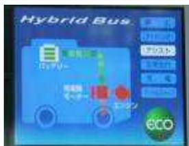
モーター駆動によるエンジン補助時
