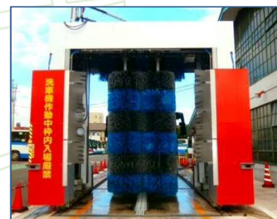
従来の1/3の水量で洗車ができる新型洗車機（イメージ）
