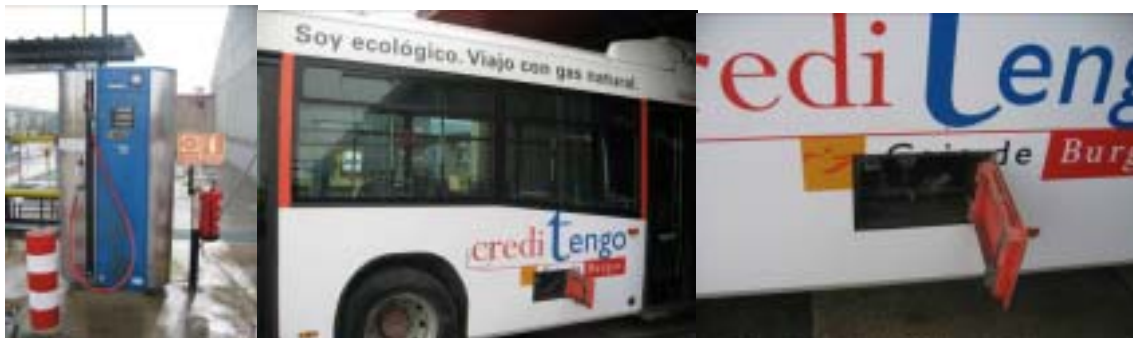
図 3(1)-2 天然ガス給油ポンプと天然ガス車
