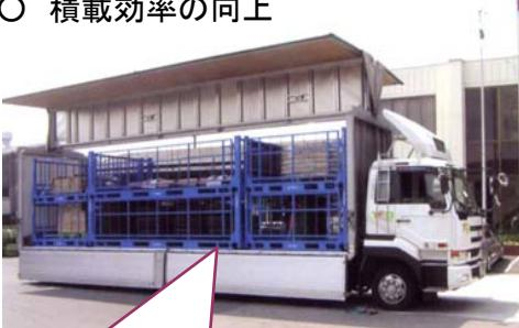
荷主別ラックの活用とトラック大型化により多数荷主の幹線輸送を共同化
