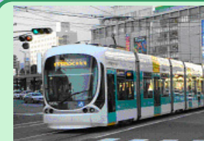
グリーンムーバーMAX (国産初の完全超低床式路面電車)
